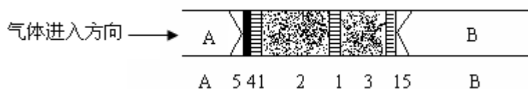
图1 玻璃采样管结构示意图
